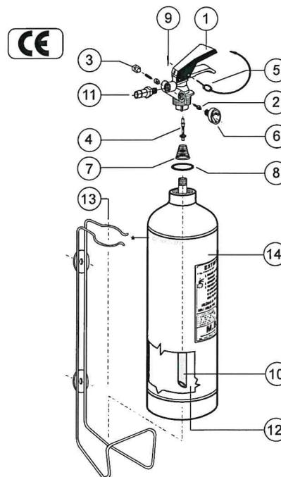
\*\* Marchiatura serbatoio: (Ente di Sorveglianza) CE 1370, produttore serbatoio, decimale anno produzione, (Codice identificativo produttore) 0095, n° matricola serbatoio, (Pressione di collaudo) PT xx Bar.
